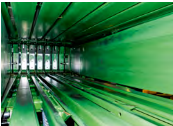
Der Presskanal wurde um 20% auf 3,60 m verlängert. Die obere Kompressionsklappe erstreckt sich über die gesamte Breite.
