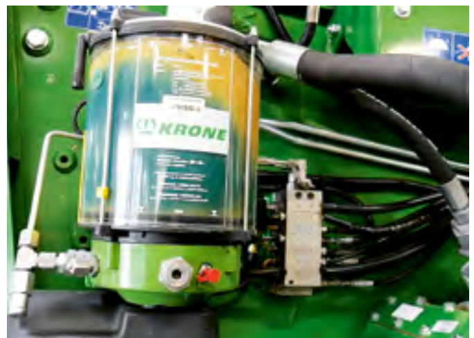
Wartungsintervalle verlängern sich dank grösser dimensionierter Zentralschmierung.
